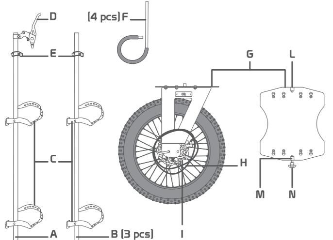
A Manico con freno montato | B Manico (3 pz.) | C Lacci in gomma per il fissaggio dei manici | D Leva del freno | E Perni (con coppiglie) per il fissaggio delle maniglie | F Maniglie (4 pz.) | G Piastra per l'aggancio alla barella | H Cavo del freno | I Freno a disco | L Inserto quadro maschio | M Inserto quadro femmina | N Volantino di serraggio
